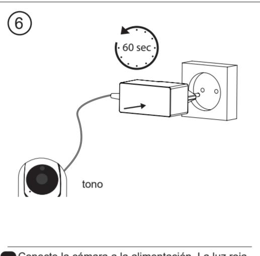
Conecte la cámara a la alimentación. La luz roja de la cámara se encenderá.
