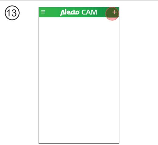
Pulse + situado en la parte superior de la pantalla para añadir una cámara.
