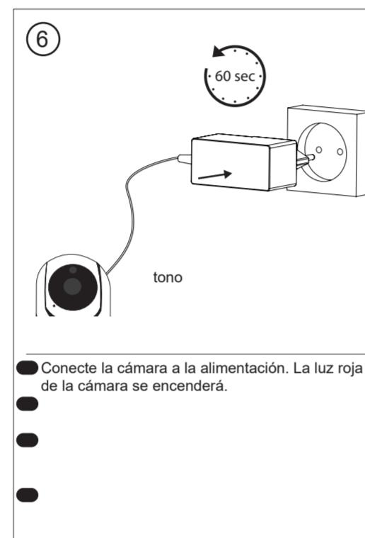
Conecte la cámara a la alimentación. La luz roja de la cámara se encenderá.
