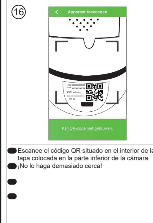
Escanee el código QR situado en el interior de la tapa colocada en la parte inferior de la cámara.
