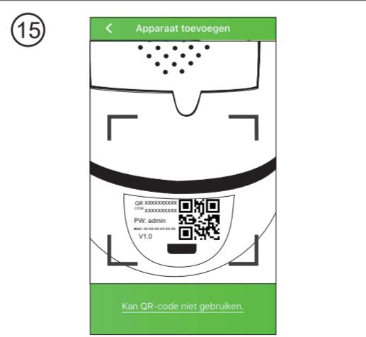
Escanee el código QR situado en el interior de la tapa colocada en la parte inferior de la cámara. ¡No lo haga demasiado cerca!
