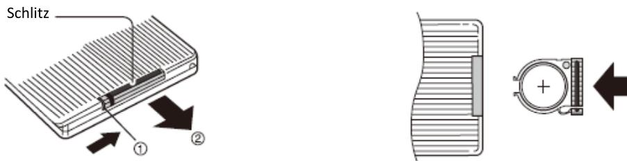
Vergessen Sie nicht, den Plastikstreifen zu entfernen, bevor Sie die Fernbedienung zum ersten Mal verwenden.
