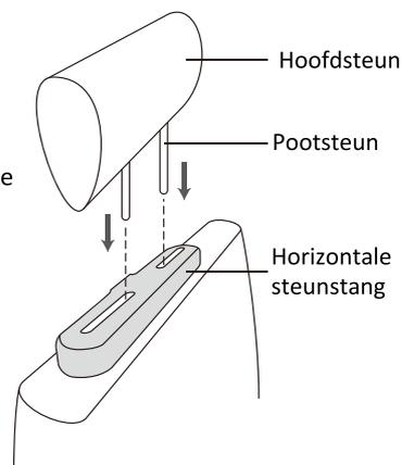
Opmerking : Gelieve, wanneer de poten van de hoofdsteun te dik zijn voor de opening van de horizontale steunbalk van de beugel, de 4 schroeven van de steunbalk van de beugel los te draaien om de opening aan te passen. Gebruik als de schroeven te kort zijn de langere schroeven (meegeleverd in de doos).
