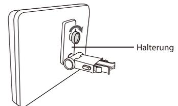
2. Ziehen Sie die Kopfstütze aus der Kopfstützenaufnahme heraus. Legen Sie die Playermontagehalterung so auf die Rückenlehne auf, dass die Öffnungen der Playermontagehalterung deckungsgleich zu den Öffnungen der Kopfstützenaufnahme sind. Achten Sie dabei darauf, dass die Playermontagehalterung sicher auf der Rückenlehne des Fahrer- bzw. Beifahrersitzes aufliegt. Stecken Sie die Kopfstütze wieder in die Kopfstützenaufnahme.
