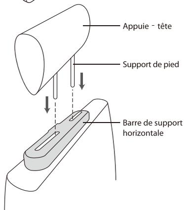
Remarque : Si les jambes du repose-tête sont trop épaisses pour permettre l'ouverture de la barre de support horizontale, dévissez les 4 vis de la barre de support pour ajuster l'ouverture. Si les vis sont trop courtes, utilisez les vis plus longues (fournies dans la boîte).
