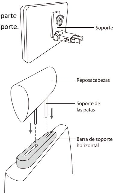
Observación : Si las patas del reposacabezas son demasiado gruesas para la apertura de la barra de apoyo horizontal de la abrazadera, por favor, desatornille los 4 tornillos de la barra de apoyo de la abrazadera para ajustar la apertura. En caso de que los tornillos sean demasiado cortos, use tornillos más largos (que se proporcionan en el envase).
