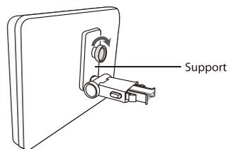
2. Levez l'appuie-tête hors de ses supports de pieds. Aligned le support horizontal avec les fentes de pieds de l'appuie-tête et vérifiez que le support horizontal repose solidement sur le haut du siège de voiture. Remontez l'appuie-tête.
