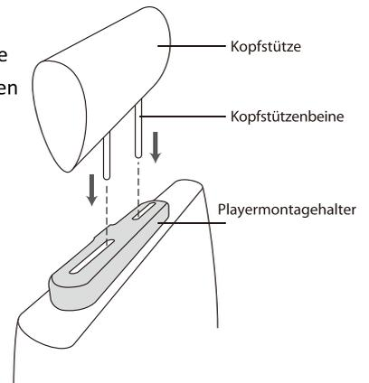
Anmerkung : Wenn die Beine der Kopfstütze zu dick für die Öffnungen der horizontalen Stützleiste der Halteklammer sind, dann lösen Sie bitte die 4 Schrauben der Stützleiste der Halteklammer, um die Öffnungen anzupassen. Wenn die Schrauben zu kurz sein sollten, dann verwenden Sie bitte längere Schrauben (mitgeliefert in der Geschenkbox).
