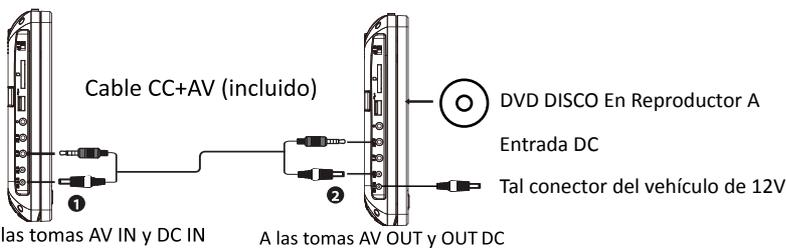
1. Conecte el reproductor de DVD A y B usando el cable DC+AV que se incluye. Conecte el cable AV en la toma AV OUT del reproductor de DVD en el que se inserte el DVD A ; conecte el otro extremo del cable AV en la toma AV IN del otro reproductor de DVD B.
