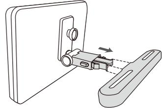
4. Stellen Sie nun die gewünschte Monitorneigung ein und sichern Sie den Monitor danach mit der Schraube rechts am Winkelhalter.
