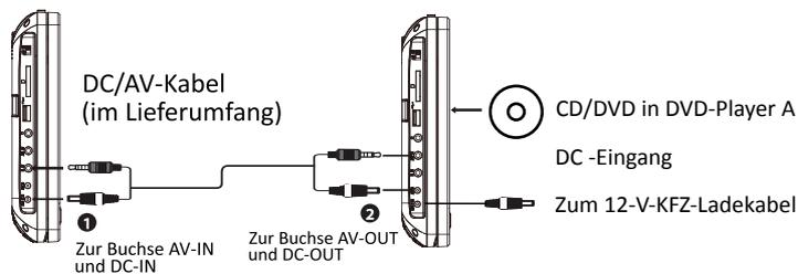
1. Verbinden Sie über das mitgelieferte DC/AV-Kabel DVD-Player A und B. Stecken Sie den Stecker des AV-Kabels in die Buchse AV-OUT desjenigen DVD-Players, in dem sich die DVD befindet A ; stecken Sie den anderen Stecker des AV-Kabels in die Buchse AV-IN des anderen DVD-Players B .
