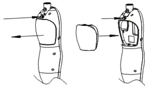
Installez le réservoir d'eau (5) sur le corps principal (C) jusqu'à ce qu'un déclic se fasse entendre
