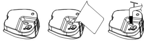
Installieren Sie den Wassertank (5) am Hauptkörper (C), bis er einrastet.
