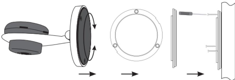
Die Kameralinse kann gedreht werden, um das Bild aufzurichten.
