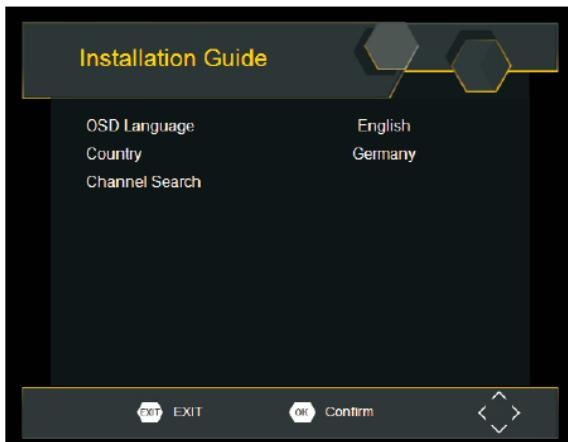
Nachdem alle Anschlüsse ordnungsgemäß vorgenommen wurden, schalten Sie das TV-Gerät ein und stellen sicher, dass der Empfänger mit dem Hauptstromversorgung verbunden ist. Drücken Sie die Taste „Power“, um den Empfänger einzuschalten. Wenn Sie den Empfänger zum ersten Mal verwenden oder ihn auf die Werkseinstellungen zurückgesetzt haben, wird auf dem TV-Bildschirm das Hauptmenü angezeigt.
