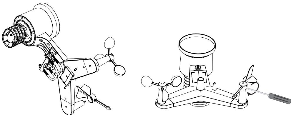
Achtung: Die Achse für die Windfahne und die Windfahne selbst sind an einem Ende abgeflacht. Dadurch wird gewährleistet, dass die Fahne nur auf eine Art über die Achse gleiten kann. Bitte beachten Sie dies während der Installation.
