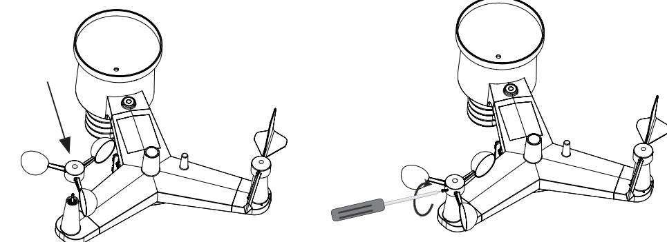
Überprüfen Sie zunächst, ob die kleine Schraube am Windfänger weit genug nach außen gedreht ist und drücken Sie dann den Windfänger über die Achse an der Inneneinheit. Drücken Sie den Windfänger hinreichend ein, aber niemals gewaltsam!
