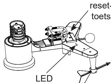
Controleer bij de binnen-unit of er waarden weergegeven worden bij 'OUTDOOR' en blaas bij de buiten-unit tegen de windvangers en giet wat water in de regenmeter en controleer of bij de binnen-unit de weergave na ongeveer 10-20 seconden wijzigt.
