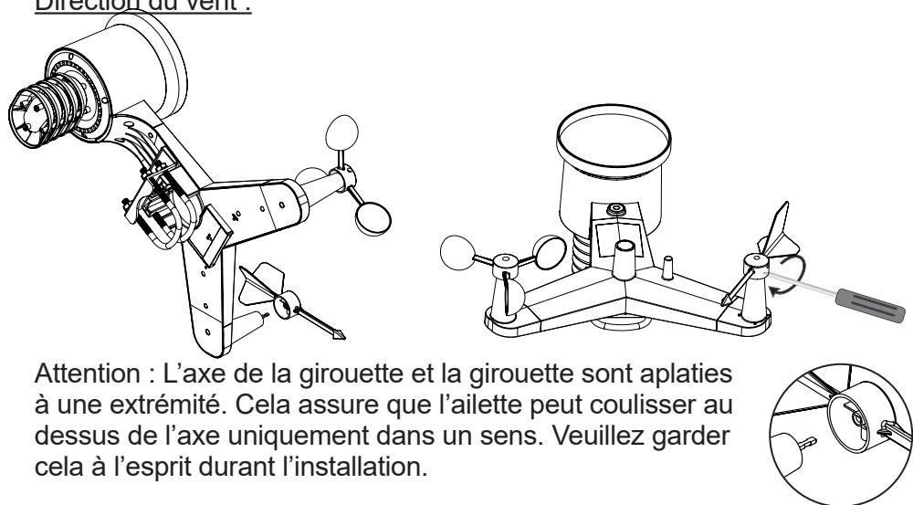
Attention : L'axe de la girouette et la girouette sont aplatis à une extrémité. Cela assure que l'ailette peut coulisser au dessus de l'axe uniquement dans un sens. Veuillez garder cela à l'esprit durant l'installation.
