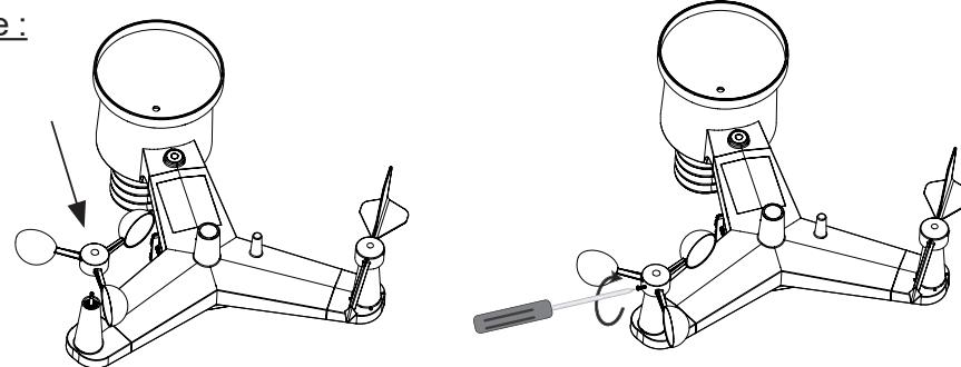
Vérifiez d'abord si la petite vis de l'anémomètre tourne vers l'extérieur assez suffisamment et qu'elle pousse l'anémomètre autour de l'axe sur l'unité extérieure. Poussez de manière adéquate l'anémomètre, mais ne forcez pas dessus!
