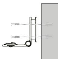
4. Coloque la unidad cámara en el soporte mural y deslícela hacia delante hasta que encaje. Conecte el adaptador de corriente a la unidad de la cámara y a una fuente de alimentación.
