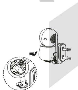
3. Introduzca los tornillos en los orificios y apriételes hasta que sólo queden visibles 6,5 mm de los tornillos.
