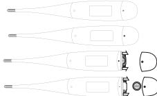
Type batterij: 1,5V, LR41 alkaline of gelijkwaardig.
