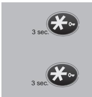
Halten Sie die \* (Stern)-Taste für 3 Sekunden gedrückt, um die Tastatur zu sperren.
