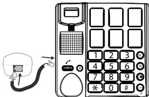
1. anslut luren till telefonen genom att fästa spiralkabelns ena ände i lurens undersida och den andra sidan i telefonens vänstra sida
