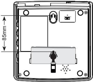
2. boor boven elkaar en met een onderlinge afstand van 8,5cm 2 gaten in de wand en plaats hierin pluggen en schroeven; laat de kop van de schroeven 5 millimeter uitsteken
