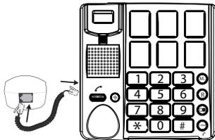
1. raccordez le cornet avec le téléphone en cliquant un bout du cordon à boucle au dessous du cornet et l'autre bout sur le côté gauche du téléphone
