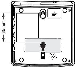
2. borra två hål i en vertikal linje på ett avstånd av 8,5 cm från varandra och sätt i pluggar och skruvar – låt skruvarnas huvud sticka ut 5 mm
