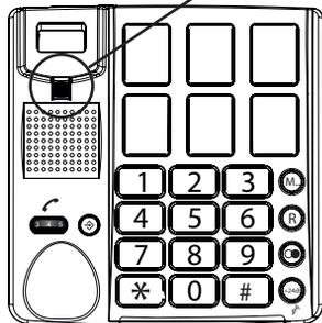
3. Træk afbryderclipsen til røret ud af telefonen, vend den 180°, og sæt den tilbage på telefonen. Denne afbryderclips holder røret på plads, når telefonen er vægmonteret
