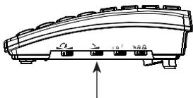
utilisez le régulateur à glissière
