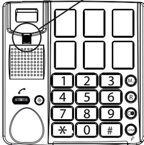
3. Schieben Sie den Telefonhöreraufhängelclip aus dem Telefon, drehen diesen um 180° und setzen diesen wieder in das Telefon ein; diese Lippe hält den Telefonhörer fest bei hängenden Gebrauch.
