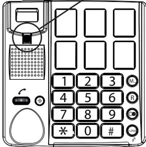
3. skjut ut klykan ur telefonen, vrid den 180 grader och sätt tillbaka den på telefonen – denna klyka håller luren vid väggmontering
