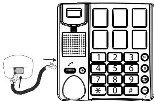
1. de hoorn met de telefoon verbinden door een zijde van het kruisnoer onder in de hoorn te klikken en de andere zijde aan de linkerzijde van de telefoon te klikken
